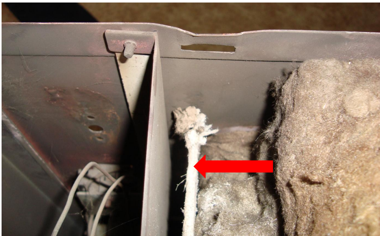
Obr. 3. Ilustrační foto. Jedna z azbestových izolačních desek v konstrukci akumulčních kamen.
